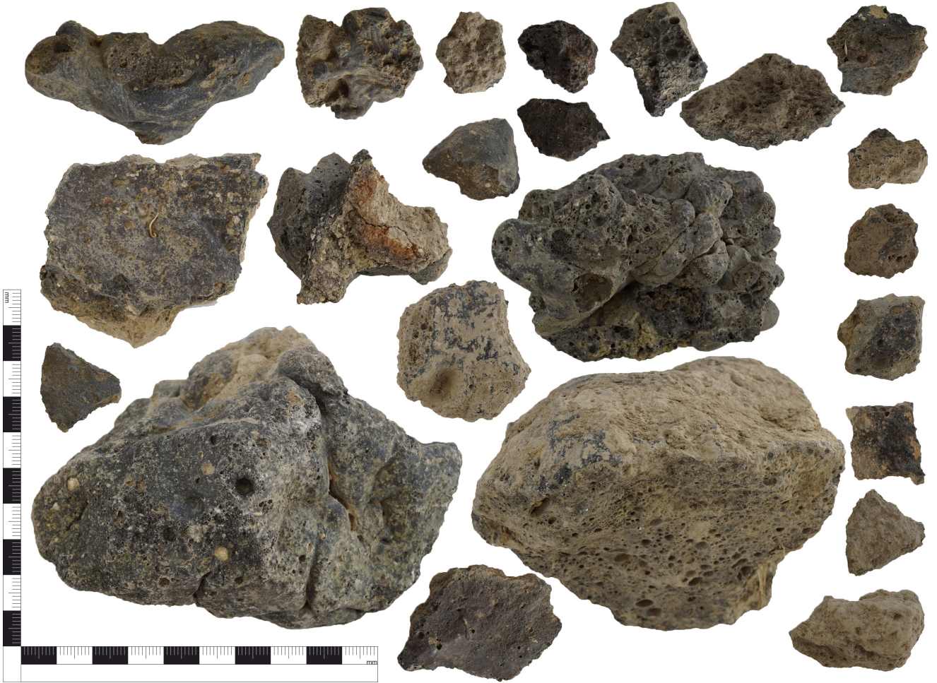
Fig. 9: Cüruf ve fırın tuğlası parçaları (Seleukeia Sidera Arşivi).
